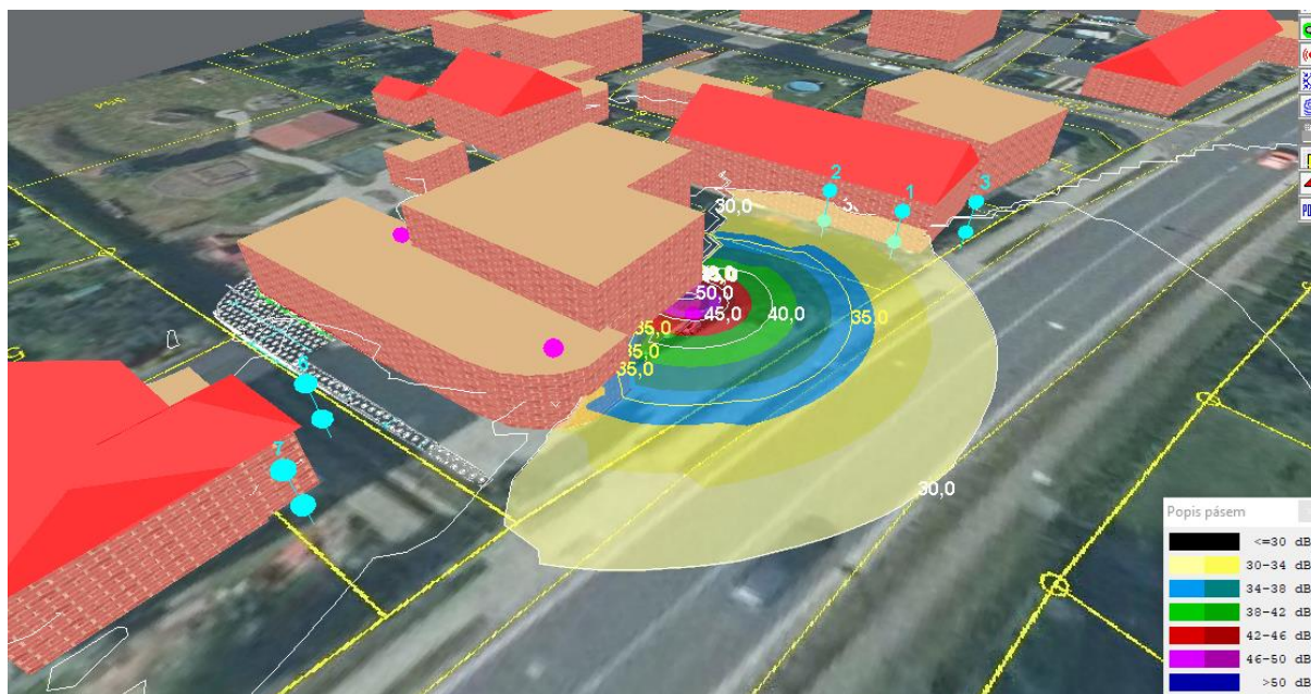
Obr. č. 7 - vykreslení izofonových pásem ve 3D modelu, výška 2 m
